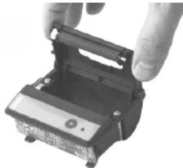
Den in der Abdeckung befindlichen Hebel leicht nach oben drücken. Die Druckrolle wird zusammen mit der Abdeckung aus dem Druckermechanismus angehoben.
