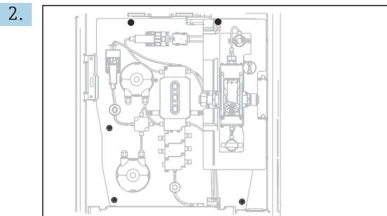
Die 5 Schrauben der Trägerplatte mit einem Torx-Schraubendreher (T25) lösen.
