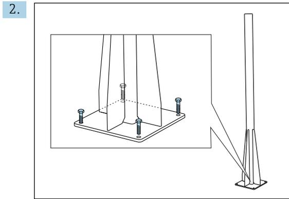
Mast aufrichten und mit 4 Befestigungsschrauben (*bauseits zu stellen*<sup>1)</sup>) sicher am Fundament montieren.
