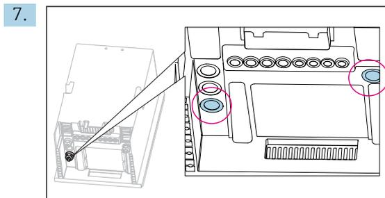
Beheizten Abfallschlauch (im Bild links) und beheizten Probenschlauch (im Bild rechts) durch die gezeigten Kabelverschraubungen führen.
