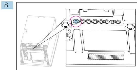
Das bauseitige Versorgungskabel durch die gezeigte Kabelverschraubung führen.
