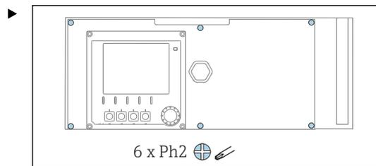
Die 6 Schrauben der Elektronikraum-Abdeckung mit einem Kreuzschlitz-Schraubendreher lösen und die Abdeckung nach vorn klappen.
