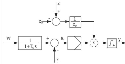
Streng genommen handelt es sich bei einer Störgrößenaufschaltung um eine Steuerung, da deren Auswirkung nicht unmittelbar gemessen wird. Das bedeutet, der Wirkungsfluss ist ausschließlich nach vorne gerichtet. Daher auch die englische Bezeichnung "Feedforward Control".
