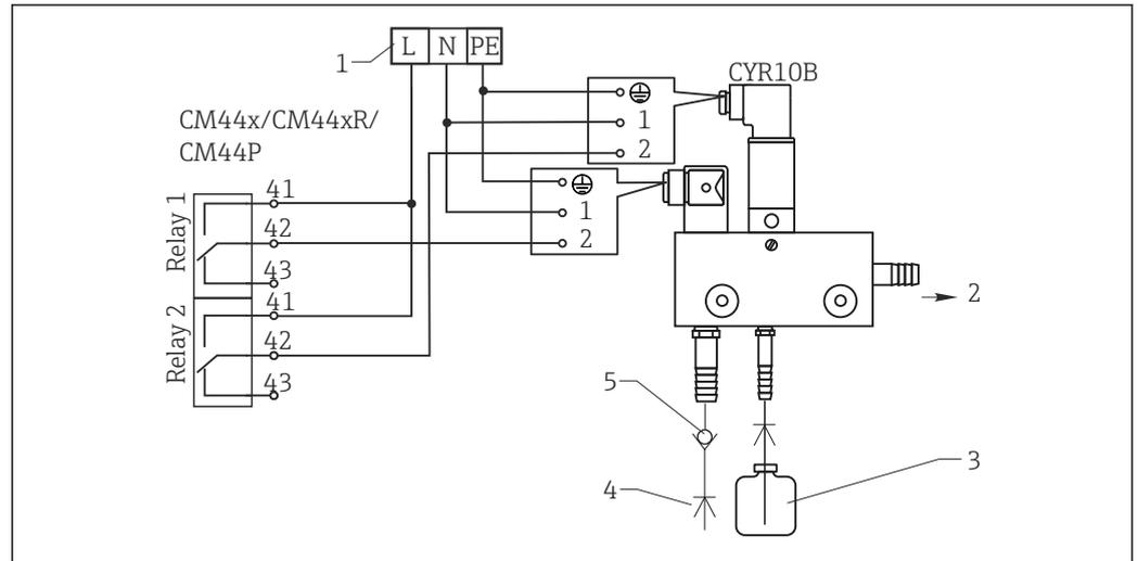
48 Anschluss der Injektor-Reinigungseinheit CYR10B
