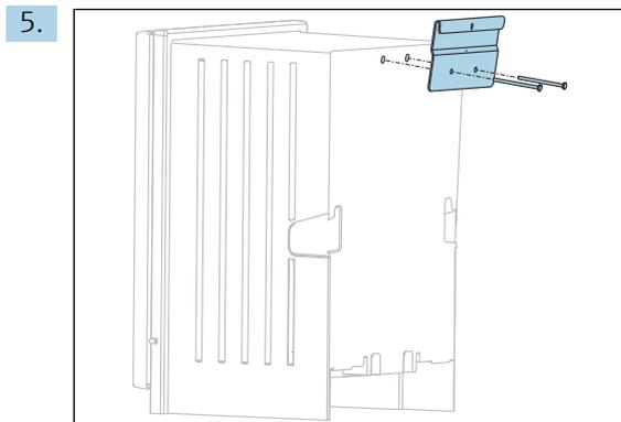
Aufhängung der Wandhalterung (aus Lieferumfang Analysator) am Analysator anschrauben.
