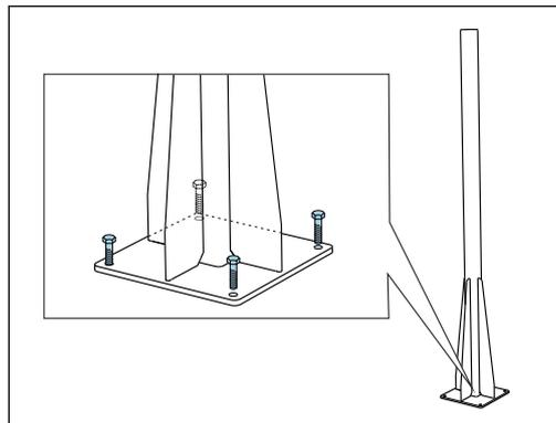
Mast aufrichten und mit 4 Befestigungsschrauben (*bauseits zu stellen*<sup>1)</sup>) sicher am Fundament montieren.
