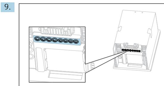
Die Kabel durch die Kabelverschraubungen am Boden des Geräts führen.
