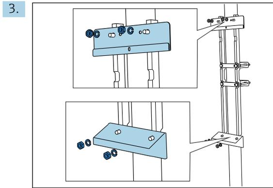
Wandhalter (aus Lieferumfang Analysator) an die Masthalterung montieren.
