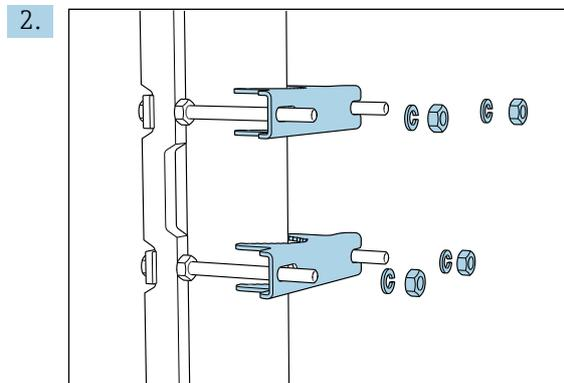
Gegenstücke aufziehen und Masthalterung durch Federringe und Muttern fixieren.
