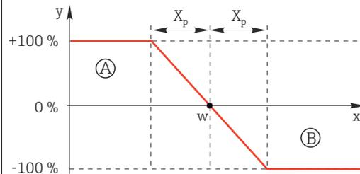
79 Rot: Überlagerung der Kurven der beiden 1-seitigen Regler.
