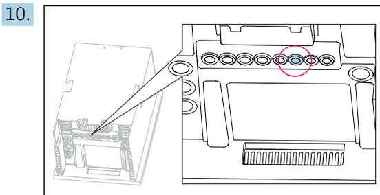
Das Kabel des beheizten Abfallschlauchs durch die gezeigte Kabelverschraubung führen.
