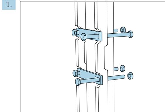
Schelle der Masthalterung an Haltestangen und Mast durch Muttern fixieren.
