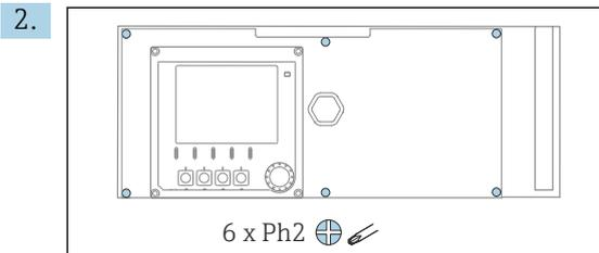
Die 6 Schrauben der Elektronikraum-Abdeckung mit einem Kreuzschlitz-Schraubendreher lösen und die Abdeckung nach vorn klappen.
