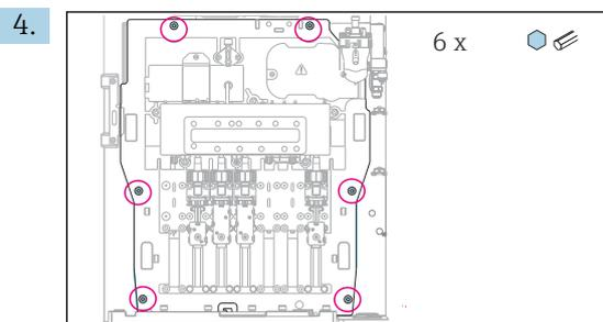
Die 6 Schrauben der Trägerplatte mit einem Innensechskantschlüssel lösen.
