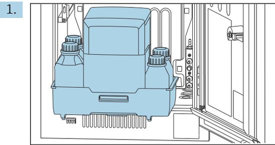
Den Flaschenkorb entnehmen: Griffmulde leicht nach oben anheben und nach vorn ziehen.
