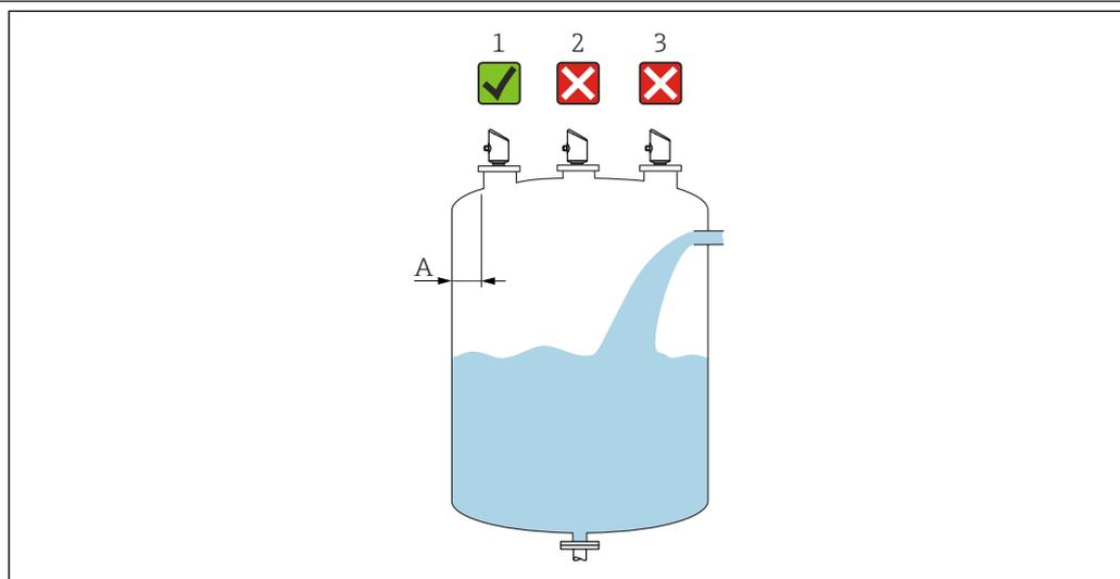
A 内壁からノズル外端までの推奨距離 : タンク直径の約 1/6。ただし、いかなる場合でも、内壁に対して 15 cm (5.91 in) 以上接近して機器を取り付けることはできません。
