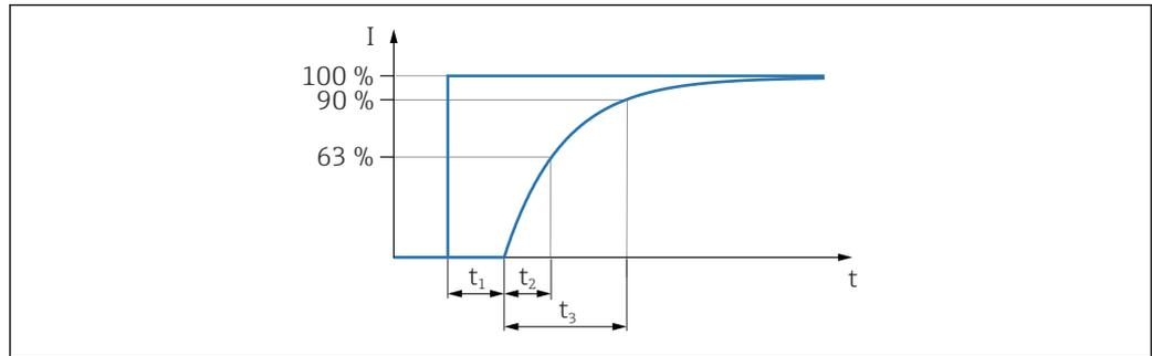
**Comportamiento dinámico, salida de corriente (electrónica HART)**
