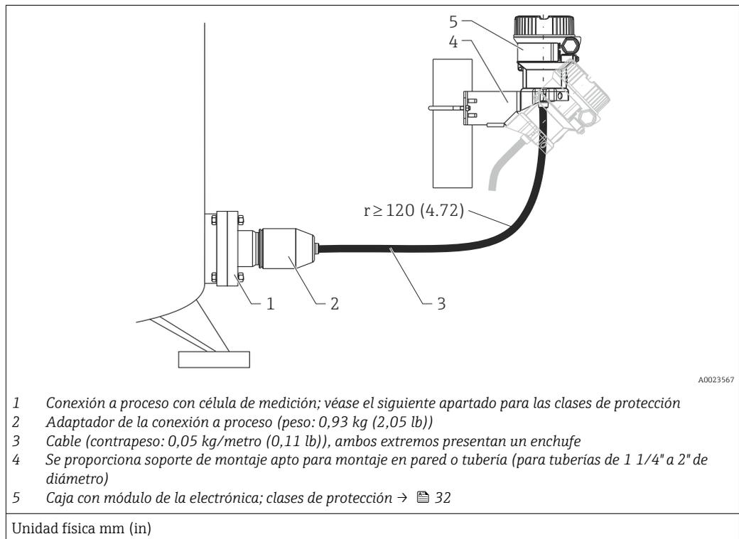
Grado de protección para la conexión a proceso y célula de medición con el uso de
