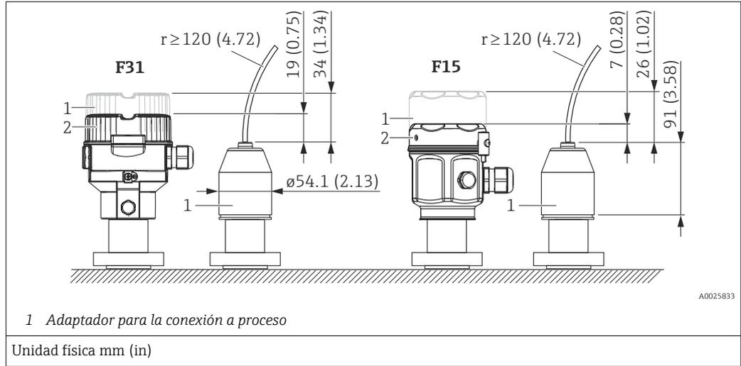
**FMB51, FMB52: Reducción de la altura de instalación**
