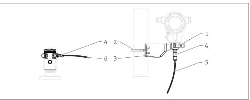
Позиция Компонент Материал Кронштейн: AISI 316L (1.4404) Монтажный кронштейн 2 Винт и гайки: А4-70 3 Полукорпуса: AISI 316L (1.4404) 4 Разъем М12 Полипропилен и нержавеющая сталь 5 Кабель для подключения преобразователя РЕ-Х, без галогенов 6 РЕ-Х, без галогенов Кабель для подключения датчика
