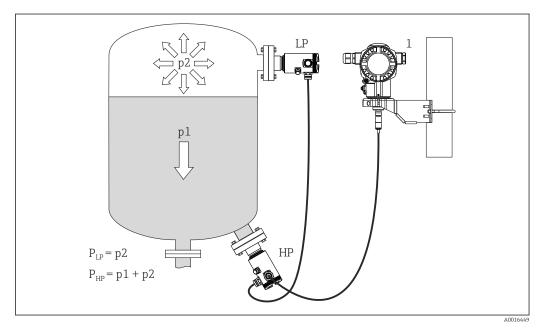
LP Модуль датчика LP (низкое давление)
