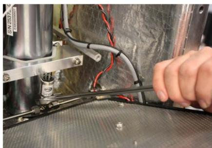
Figura 38. Retirada del sensor de presión
