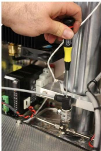
Figura 36. Retirada del tornillo del capuchón del arnés
