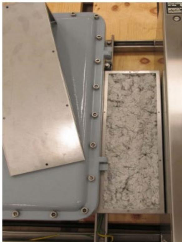
Figura 41. Retirada del aislamiento de la envolvente
