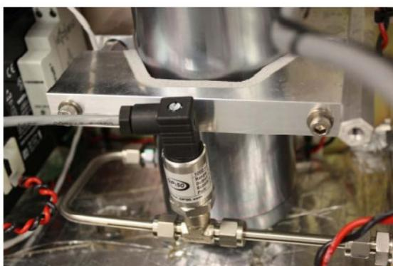
Figura 40. Sensor de presión nuevo instalado
