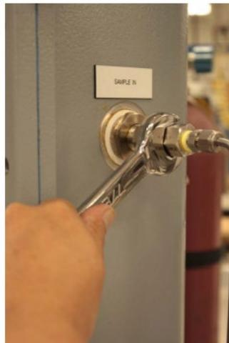
Figura 43. Retirada del parallamas
