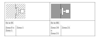
El equipo está diseñado para funcionar en atmósferas de gas explosivo o de polvo explosivo, como se muestra en el esquema anterior. En caso de que puedan darse a la vez mezclas potencialmente explosivas de gasaire y de polvo-aire: Se requiere un análisis de idoneidad más detallado.
