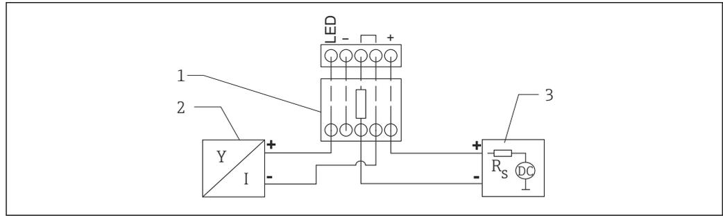
15 Diagrama de funciones del equipo HART, RIA15 con luz, módulo de resistencia para comunicaciones HART
