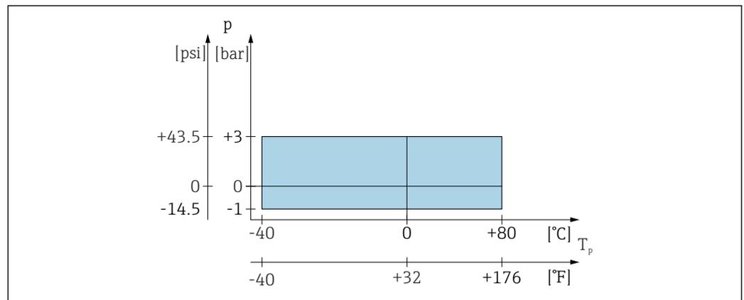
59 Rango admisible para la temperatura y la presión de proceso
