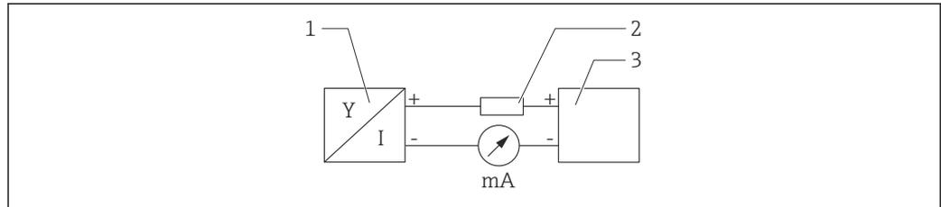
11 Diagrama de funciones de la conexión HART
