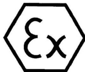
Figura 6. Etichetta ATEX per impiego in aree a rischio d'esplosione
