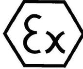
Figura 6. Etiqueta "ATEX" para uso en áreas de peligro
