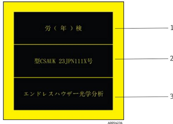
Figura 8. Etiqueta JPEX para uso en áreas de peligro
