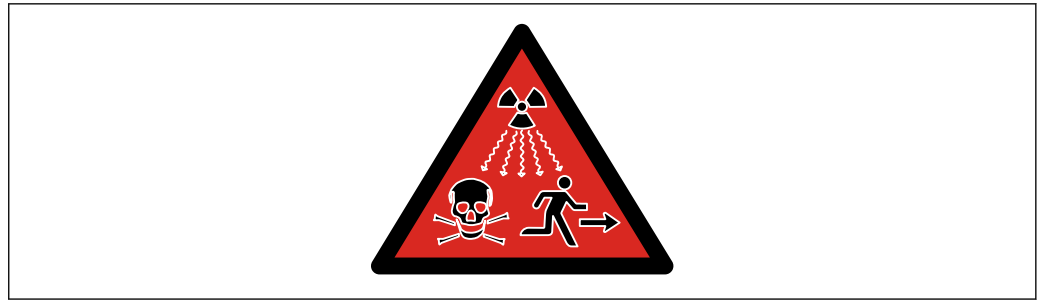
1 Warningsymbol für hochradioaktive Quelle nach ISO21482
