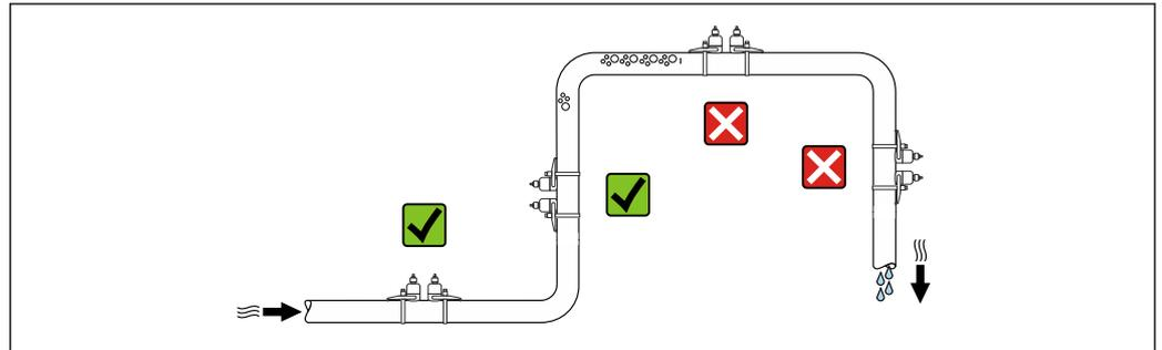
Para evitar que la acumulación de burbujas de gas en la tubería de medición provoque errores de medición, evite los siguientes lugares de montaje en las tuberías:
