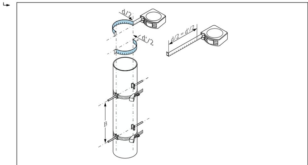
28 Posicionamiento de las abrazaderas y de los pernos de montaje con una cinta métrica (pasos 2 a 4)
