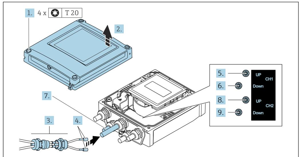
37 Transmisor: módulo del sistema electrónico principal con terminales
