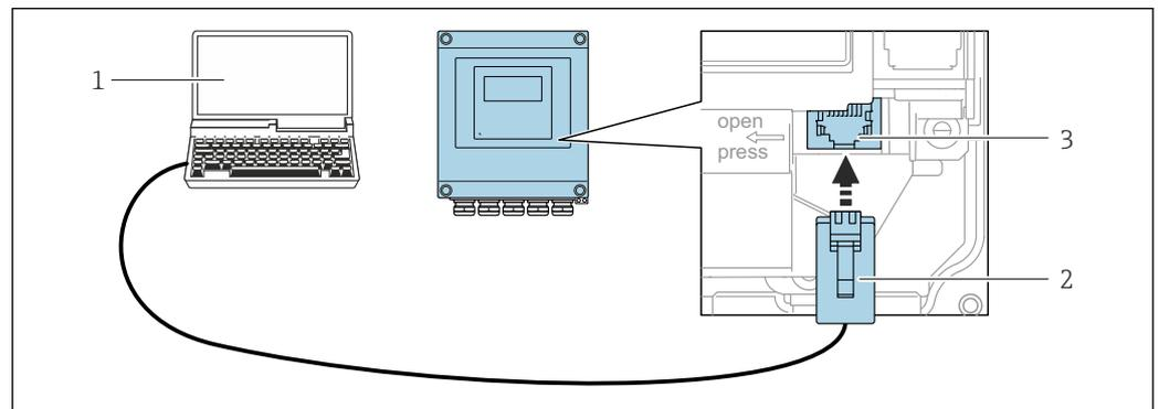
46 Conexión mediante la interfaz de servicio (CDI-RJ45)
