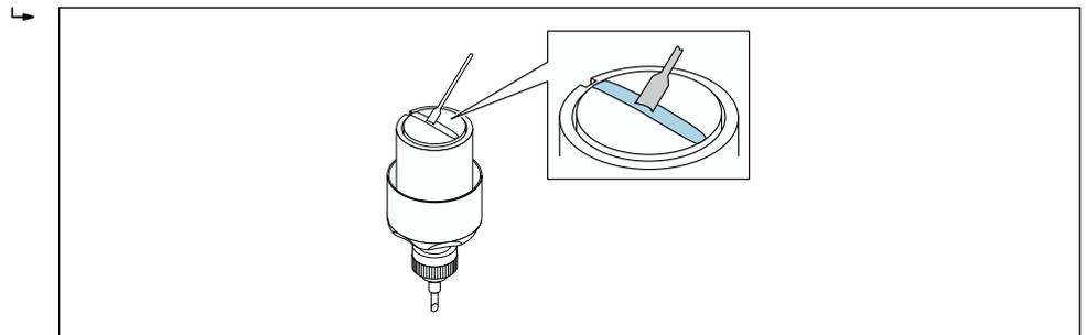
30 Recubrimiento de las superficies de contacto del sensor con gel de acoplamiento (si no se dispone de almohadilla de acoplamiento)
