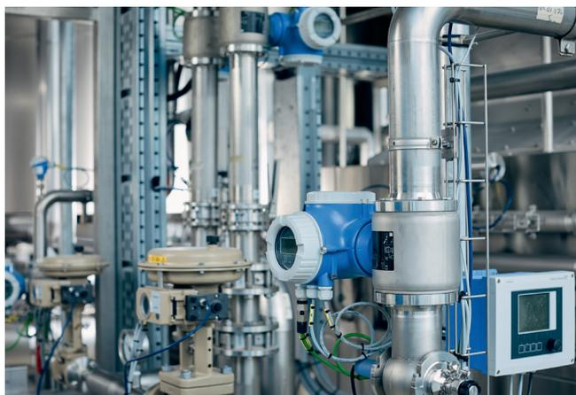
エネルギーを使用するすべての装置には、エネルギーメーターが装備されています: Promag H電磁流量計と温度センサーで、モルトグラインダーに使用される水を混合弁で監視しています。
