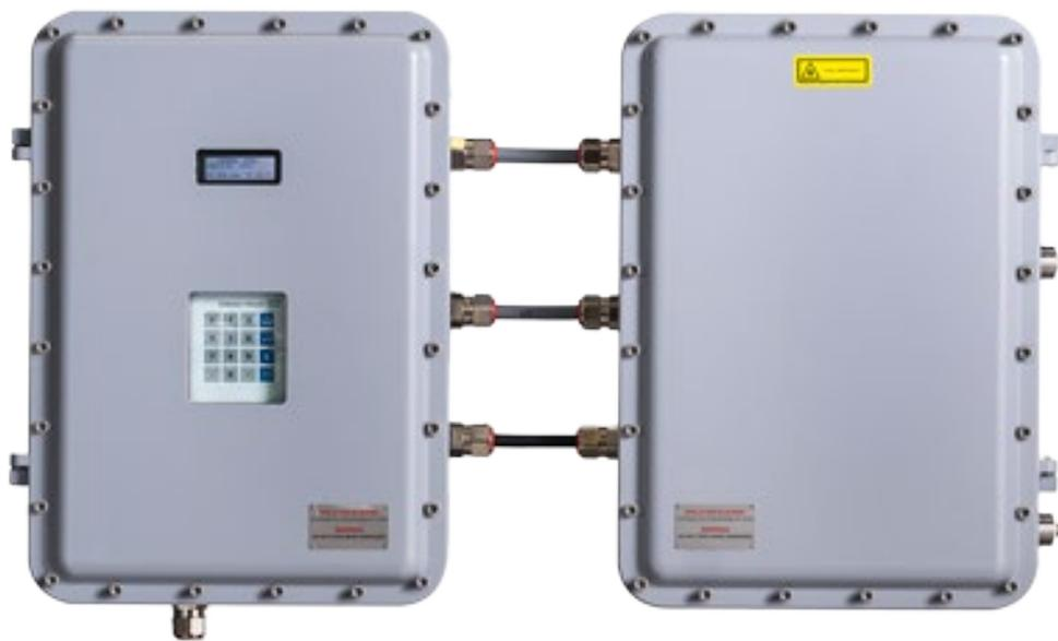
Einkanaliger TDLAS-Gasanalysator mit Dualbox für IECEx/ATEX Zone 1, der sich durch eine herausragende Zuverlässigkeit bei der Messung von Spurengasen auszeichnet. Erhältlich mit beheiztem Probenentnahmesystem im Gehäuse.
