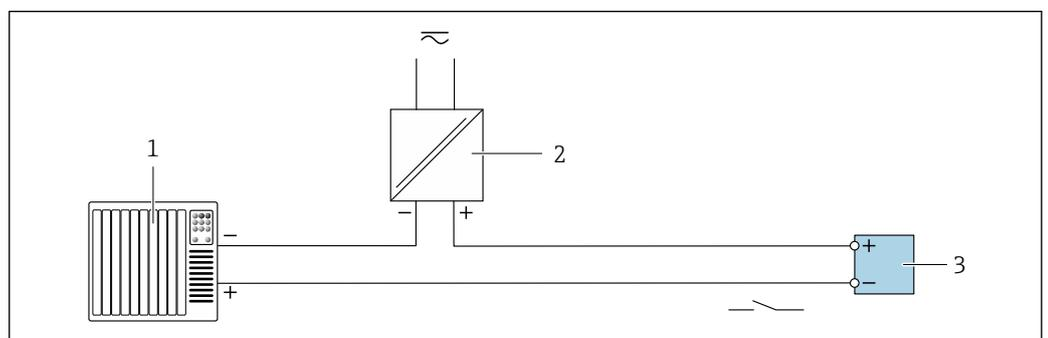
7 Esempio di connessione per uscita contatto (passiva)
