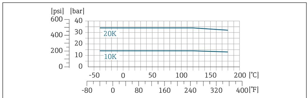
20 Materiale della connessione flangiata: acciaio inox, certificazioni multiple, 1.4404/F316/F316L
