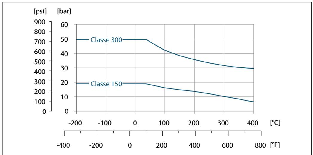
19 Materiale della connessione flangiata: acciaio inox, certificazioni multiple, 1.4404/F316/F316L
