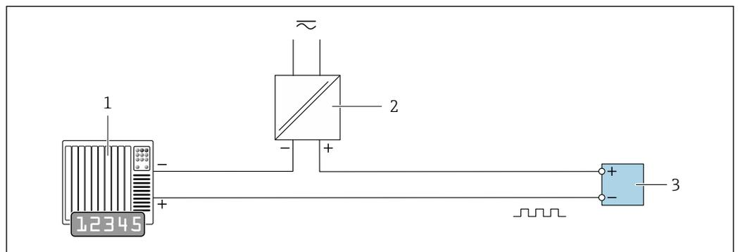
6 Esempio di connessione per uscita impulsi/frequenza (passiva)
