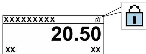
Fig 71. Símbolo de bloqueo por hardware en el indicador operativo
