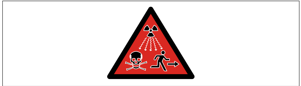
1 Símbolo de advertencia para fuente altamente radiactiva según ISO 21482
