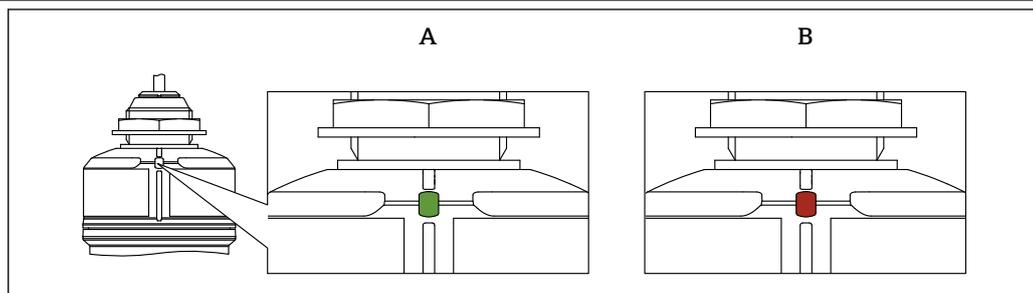
図 27 機器の LED インジケータ
