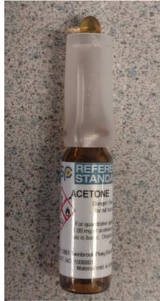
Abbildung 3: Acetonampulle mit Ampullenbrecher
