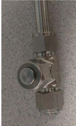
Abbildung 6: T-Messzelle in vertikaler Position
