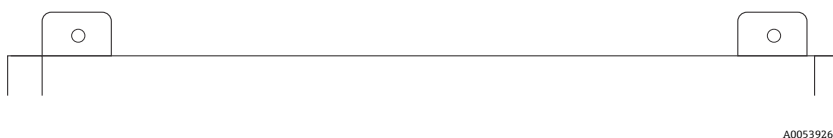
图 10. 外壳的顶部安装舌片
