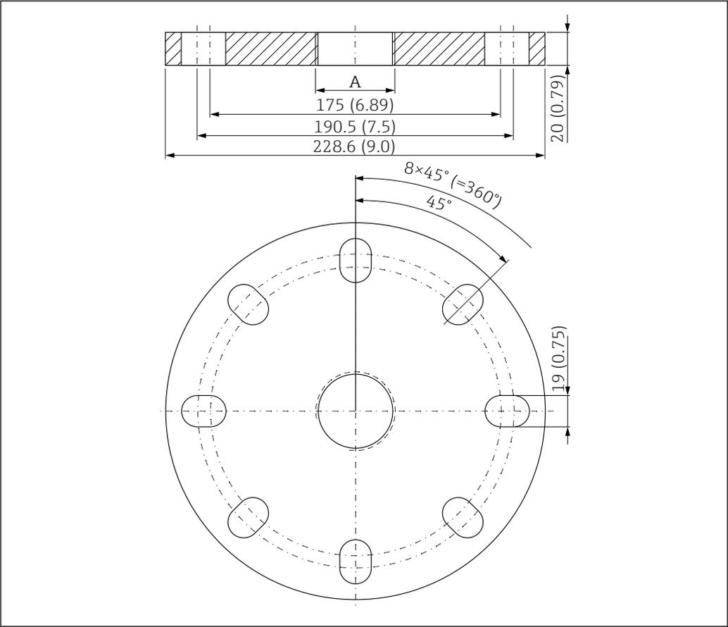
58 Abmessungen UNI Flansch 4"/DN100/100. Maßeinheit mm (in)
