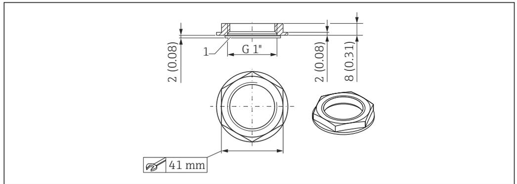
25 Abmessungen; Gegenmutter Prozessanschluss Kabeleinführung von oben. Maßeinheit mm (in)
