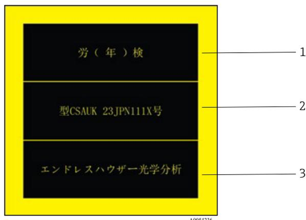
図 9. 危険場所で使用するための JPEX ラベル
