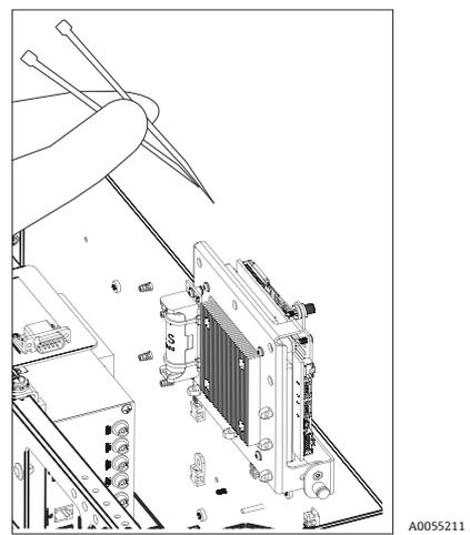
图 39: 使用电缆扎带固定新电池
