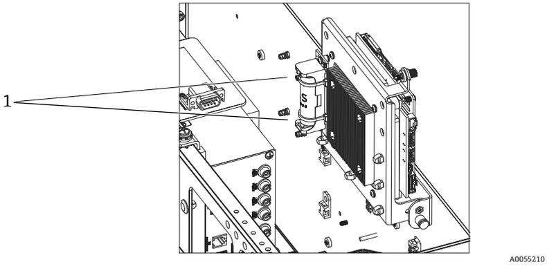
图 38: 拆下固定电池 (1) 的电缆扎带
