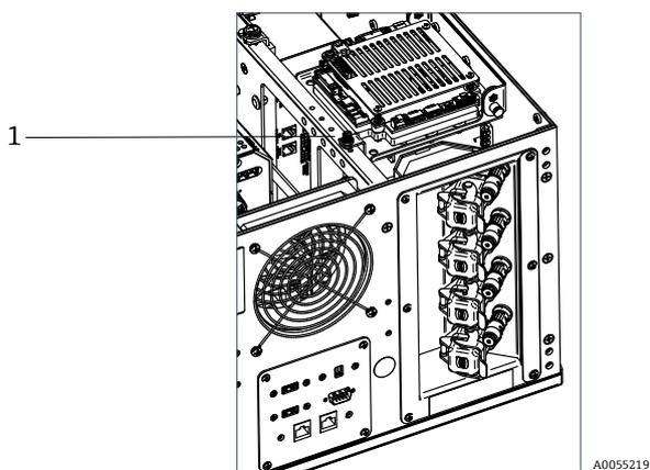
图 36: 固定内置控制器的系紧螺钉 (1)
