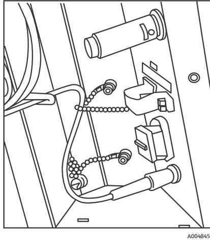
图 11: 正确连接和敷设校准光纤
