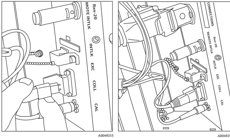
图 12: 正确连接和敷设采集光纤
