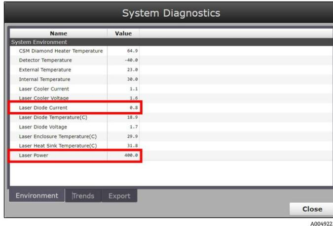
图 31: Environment 选项卡, 供用户查看激光二极管电流和激光功率
