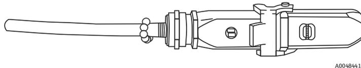
图 4: 带保护盖的光电光纤连接头
