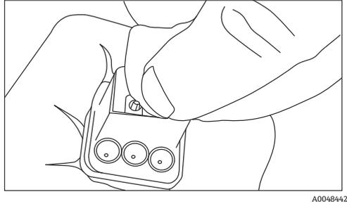
图 5: 清洁带保护盖的光电光纤连接头
