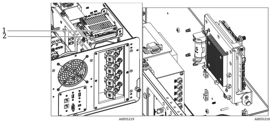
图 37: 控制器板处于开启位置时的后部概览
