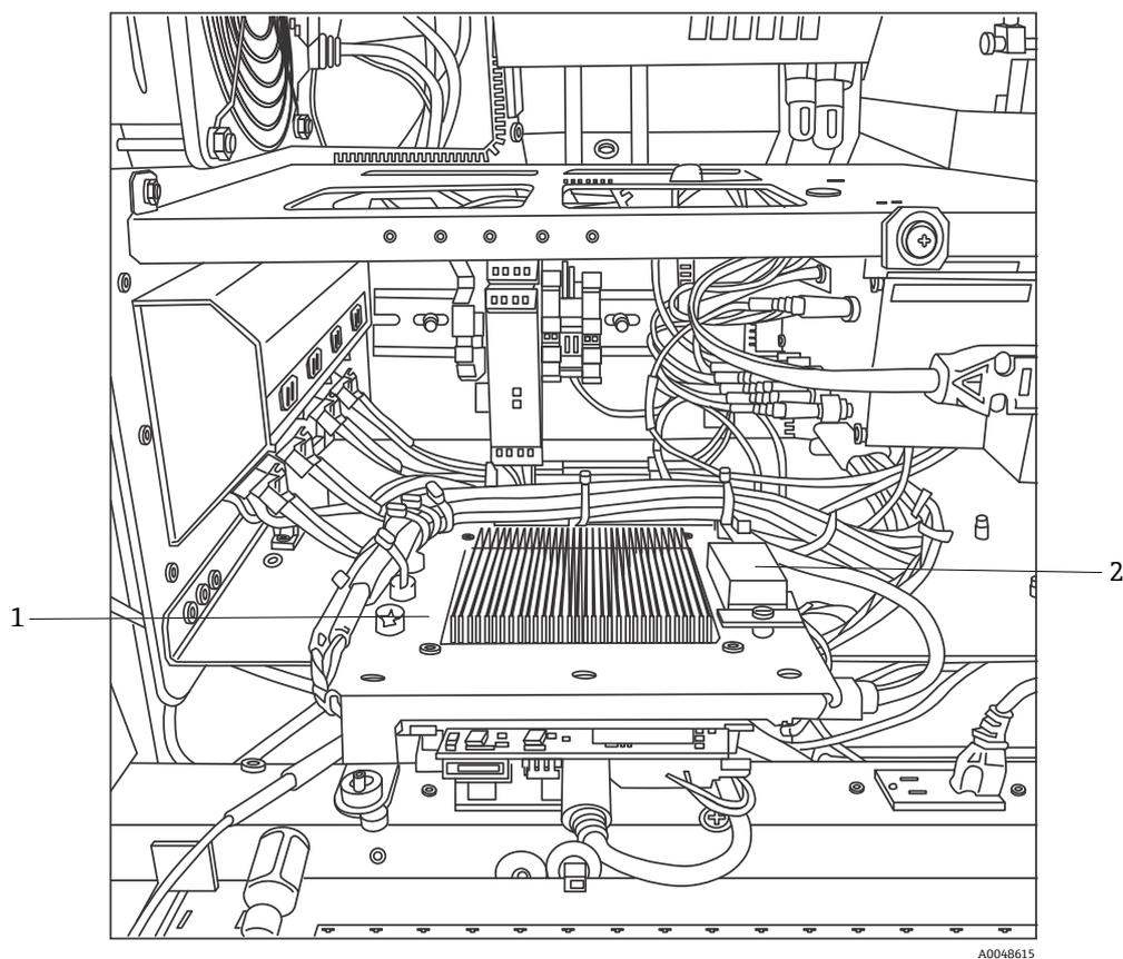
图 24: 锁定在服务位置的内置控制器
