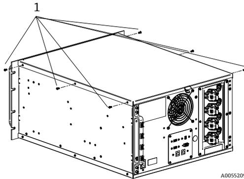
图 33: Rxn4 拉曼光谱分析仪指旋螺钉 (1)
