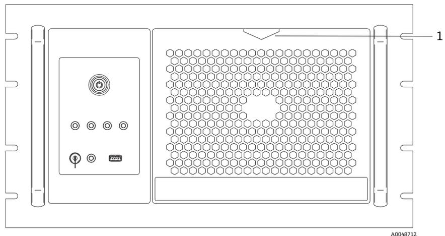
图 5. 拉出 (1) 以便检修空气过滤器
