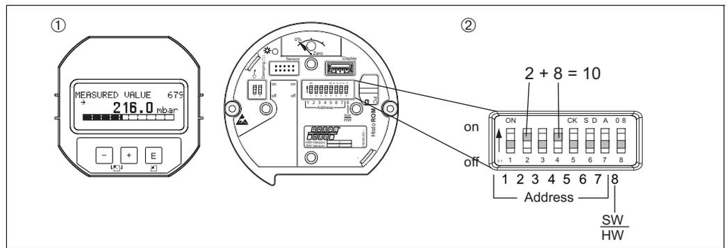
图 14: 使用 DIP 开关设置设备地址
