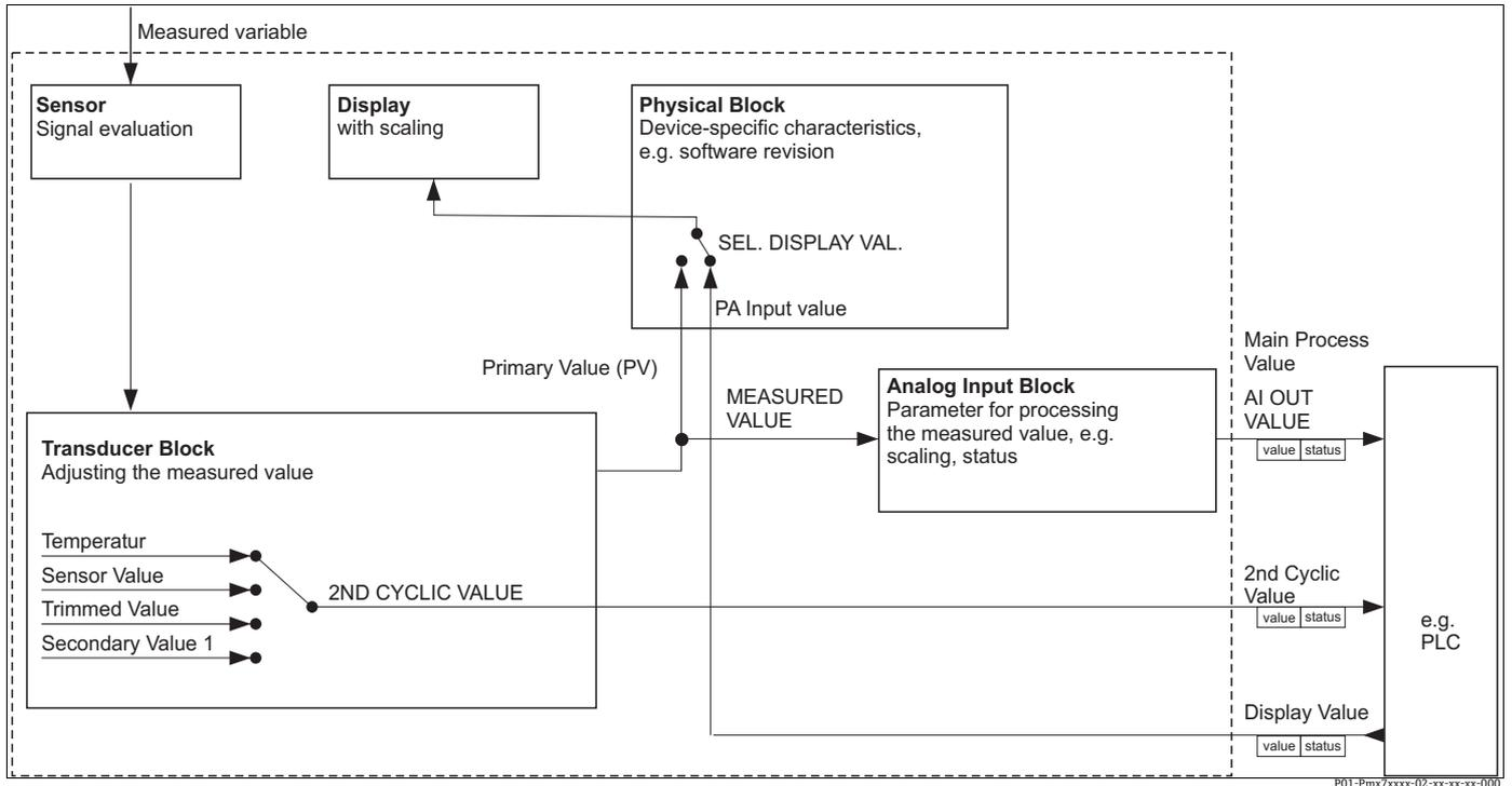
图 16: 块模型显示在循环数据交换期间, Cerabar S 和 1 类主站 (例如 PLC) 之间的数据类型。使用 PLC 的组态设置软件并通过模块编译循环数据电报 (另见本章节中的“循环数据图表模块”)。调试软件 (例如 FieldCare) 参数以 CAPS 写入, 可用于对循环数据电报或显示值进行设置 (参见本章节中的“参数说明参数说明”)。
