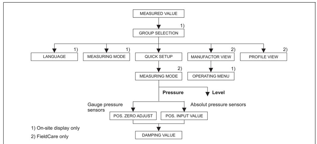
图 19: “Pressure” 测量模式的 Quick Setup 菜单
