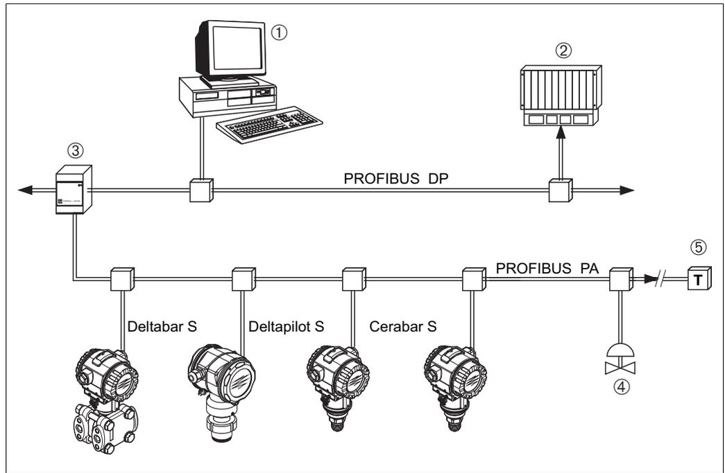
图 13: PROFIBUS 系统架构
