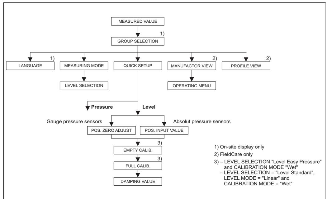
图 20: “Level” 测量模式的 Quick Setup 菜单
