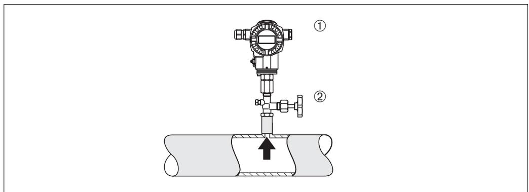
图 1: 气体压力测量布置
