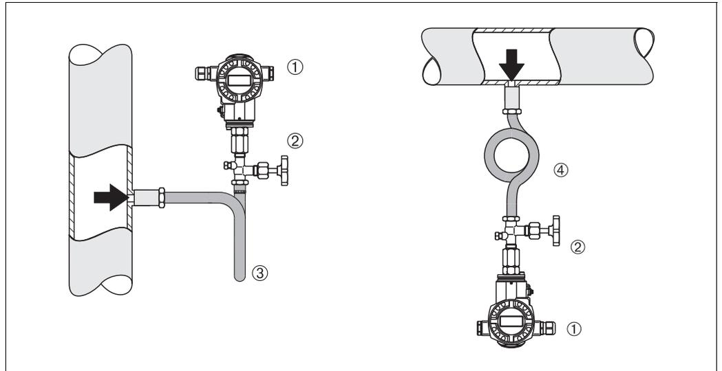
图 2: 蒸汽压力测量布置
