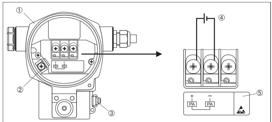
图 9: PROFIBUS PA 电气连接
