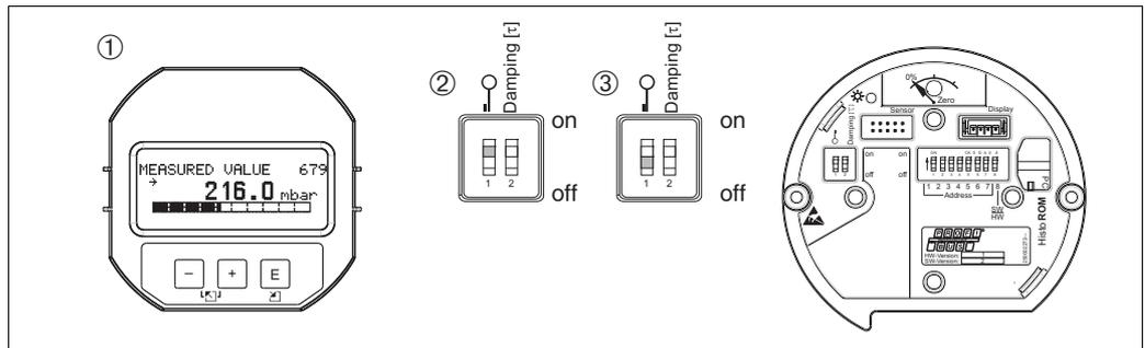
图 18: 电子插件上的 DIP 开关位置“Hardware locking”
