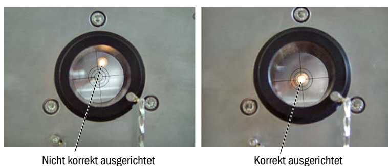
Abb. 7: Anzeige der optischen Ausrichtung - am Fenster des Justiertubus
