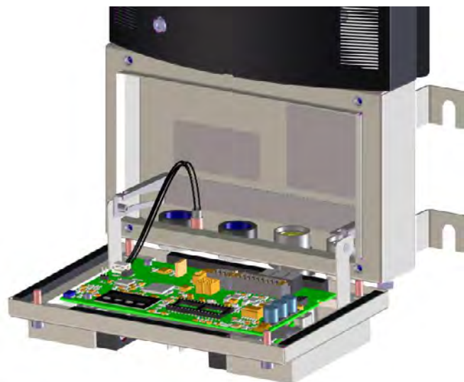
Abb. 23: Steckplatz der Leitung für die Status-LED
