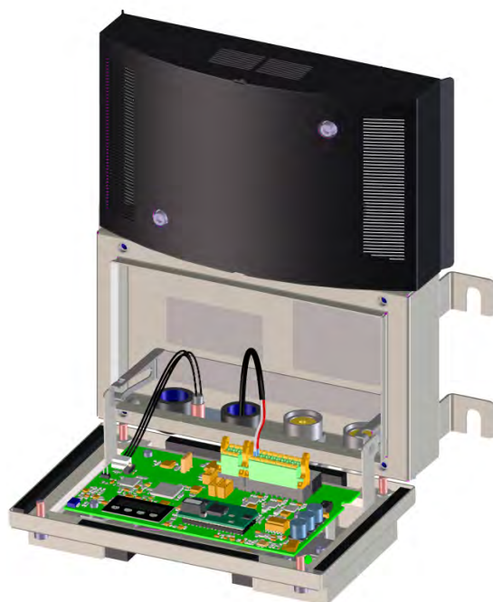
Abb. 22: Elektrischer Anschluss Temperatursensor PT1000
