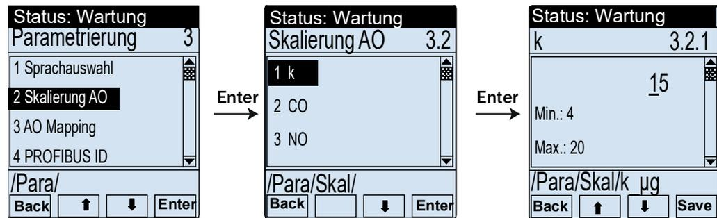
Abb. 76: Analogausgang CO skalieren
