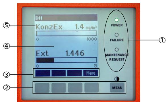
Abb. 50: Funktionselemente LC-Display Steuereinheit MCU
