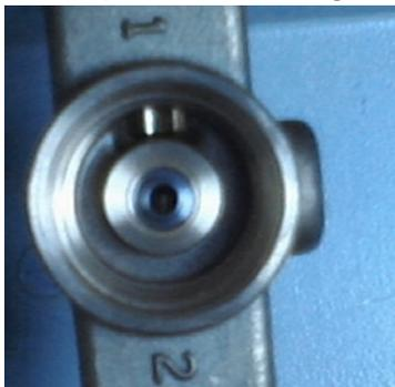
Bei sehr starken Verschmutzungen bzw. Korrosion ist das Magnetventil komplett zu erneuern.
