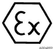
Figura 3. Etichetta ATEX per impiego in aree a rischio d'esplosione
