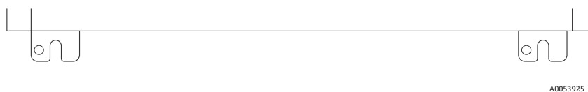
Figure 7. Pattes de fixation inférieures à fente du boîtier
