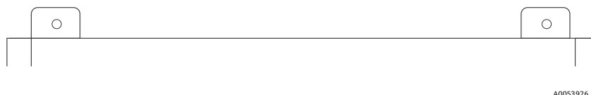
Figure 8. Pattes de fixation supérieures du boîtier
