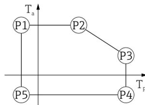
54 Gehäuse 316L, Hygiene; Prozesstemperatur -10 ... +150 °C (+14 ... +302 °F)
