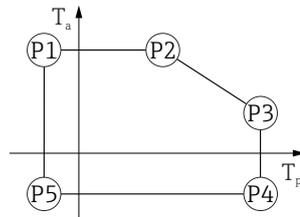
▣ 48 Gehäuse 316L; Prozesstemperatur  $-10 \dots +150 \text{ °C}$  ( $+14 \dots +302 \text{ °F}$ )
