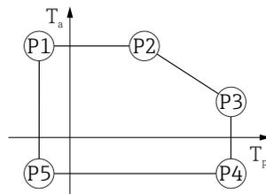
53 Gehäuse 316L; Prozesstemperatur -40 ... +200 °C (-40 ... +392 °F)
