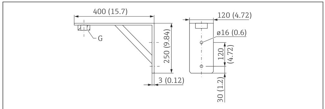
▣ 30 Размеры монтажного кронштейна. Единица измерения мм (дюйм)
