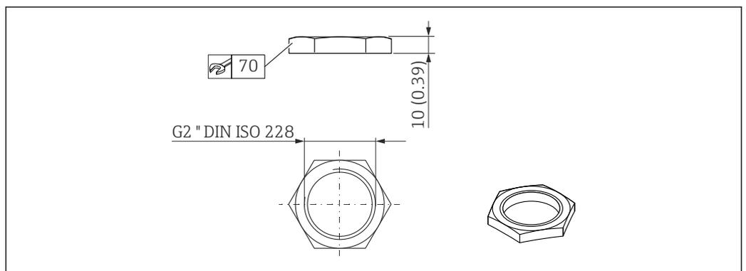
22 Размеры крепежной гайки. Единица измерения мм (дюйм)
