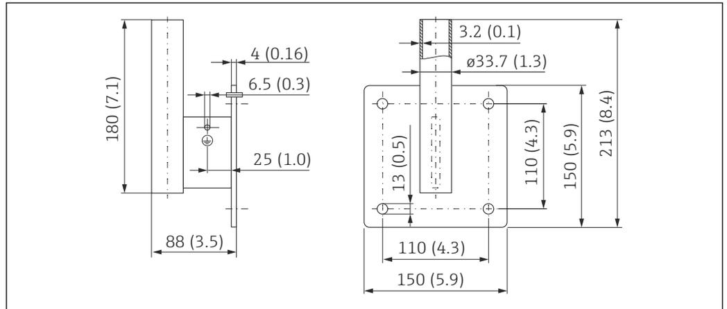
39 Размеры настенного кронштейна. Единица измерения мм (дюйм)
