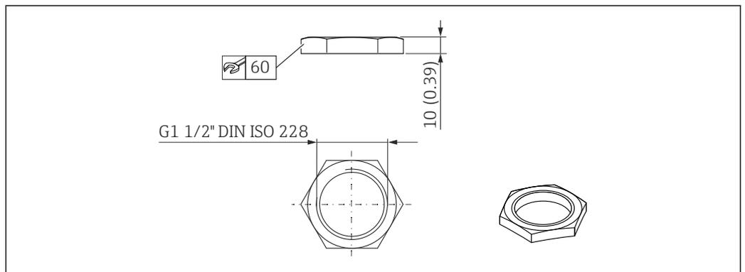
21 Размеры крепежной гайки. Единица измерения мм (дюйм)
