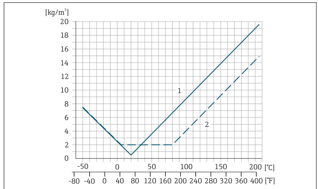
1 Калибровка по плотности на месте эксплуатации, в примере – при температуре +20 °C (+68 °F)
