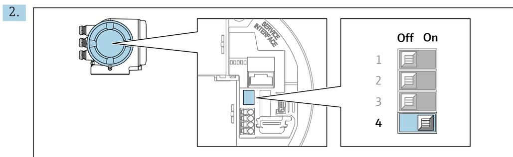
Чтобы переключить адресацию с программной на аппаратную, переведите DIP-переключатель в положение **On**.
