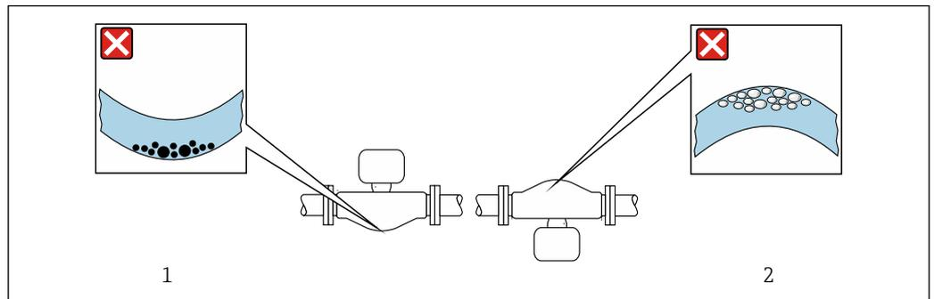
☒ 7 Ориентация датчика с изогнутой измерительной трубкой
