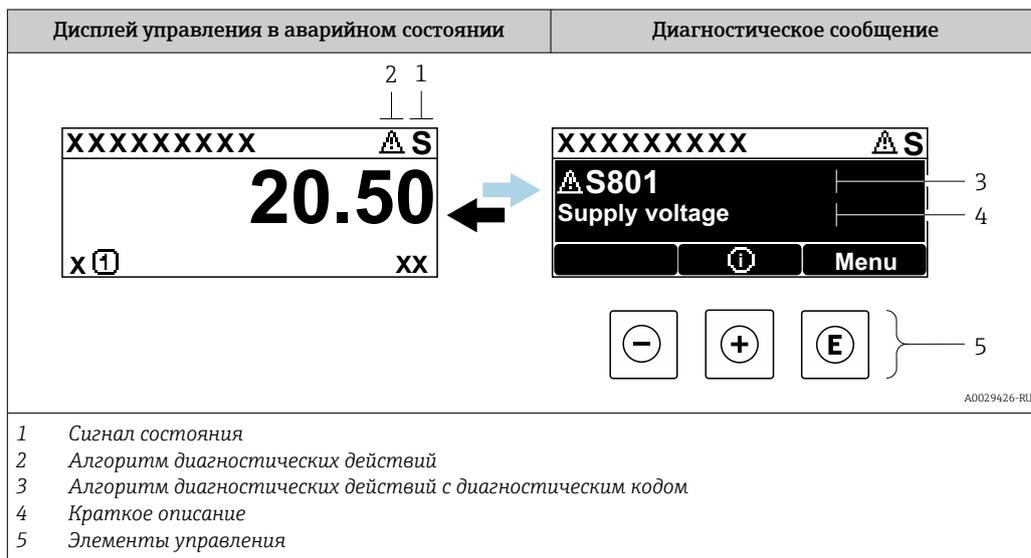
Если два или более диагностических события активны одновременно, то отображается только сообщение о диагностическом событии с наивысшим приоритетом.
