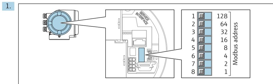
Установите требуемый адрес прибора с помощью DIP-переключателей в клеммном отсеке.
