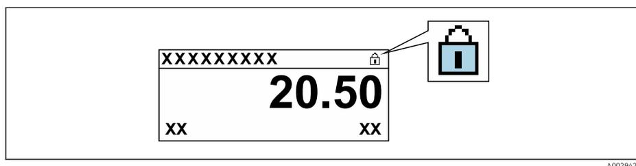
2. При переводе переключателя защиты от записи (WP) на главном модуле электроники в положение **OFF** (заводская настройка) аппаратная защита от записи деактивируется.
