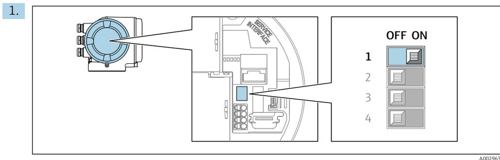
При переводе переключателя защиты от записи (WP) на главном модуле электроники в положение **ON** активируется аппаратная защита от записи.
