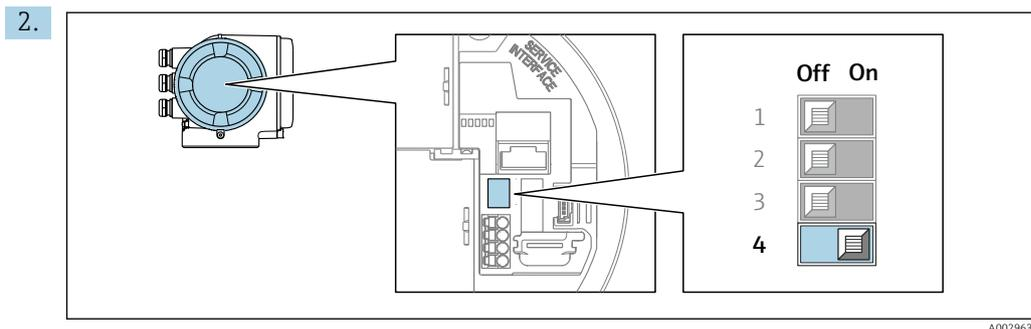
Для перехода от программной адресации к аппаратной переведите DIP-переключатель в положение **On**.
