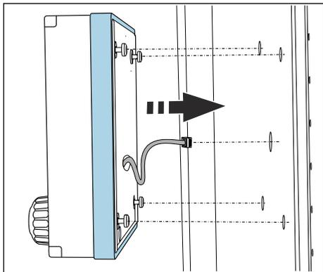
Das Displaykabel durch die mittlere Bohrung ziehen.
