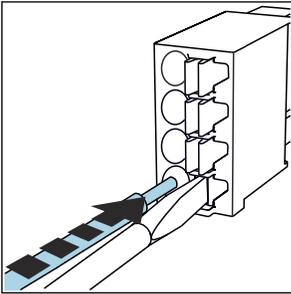
Kabel bis Anschlag einführen.
