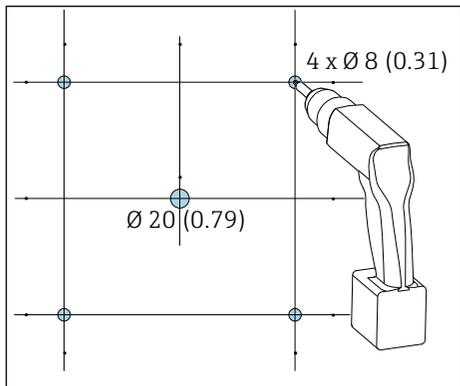
6 Durchmesser der Bohrlöcher in mm (in)
