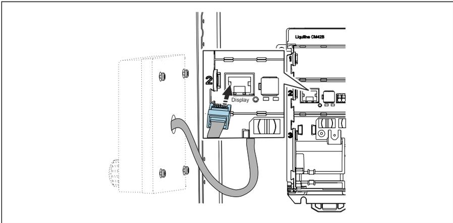
Displaykabel mit der RJ50-Buchse des Messumformers verbinden. Die RJ50-Buchse ist mit **Display** beschriftet.
