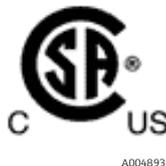
Abbildung 4. CSA-Kennzeichnung für den Einsatz in explosionsgefährdeten Bereichen in den USA und Kanada
