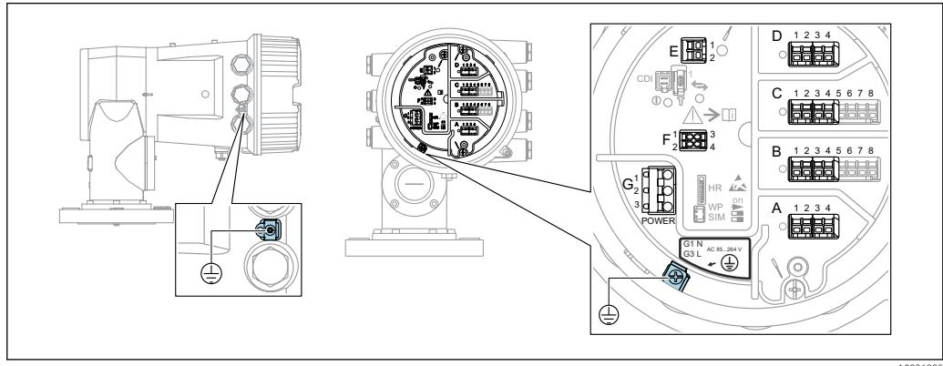
■ 11 Клеммный отсек (типовой пример) и клеммы заземления
