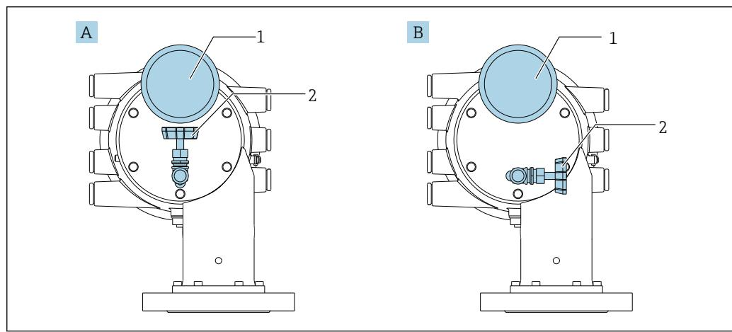
■ 29 Монтажная позиция перепускного клапана и манометра
