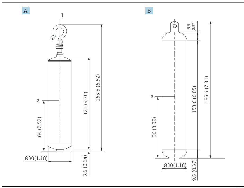
A Ø30 мм (1,18 дюйм), 316L, цилиндрический поплавок
