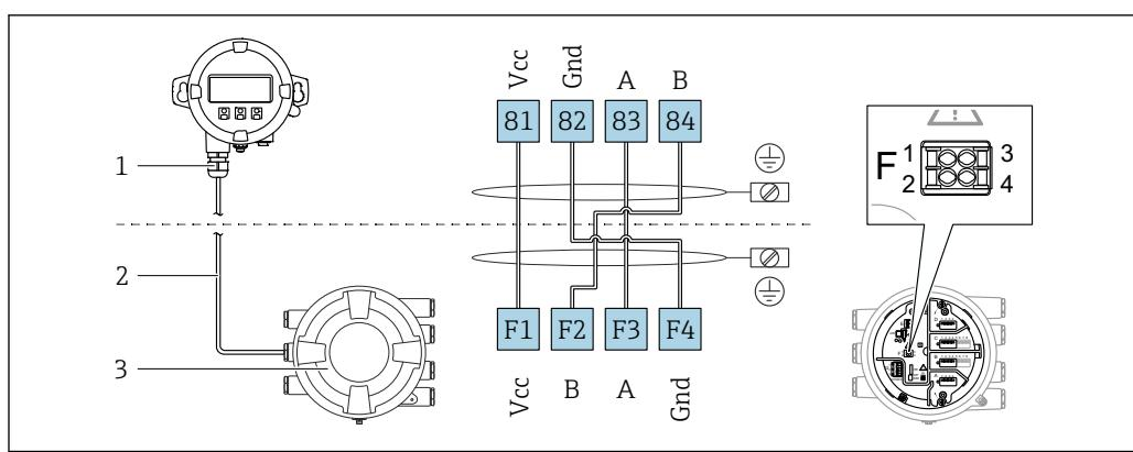
13 Подключение выносного модуля индикации и управления DKX001 к прибору для измерения уровня в резервуарах (NMR8x, NMS8x или NRF8x)
