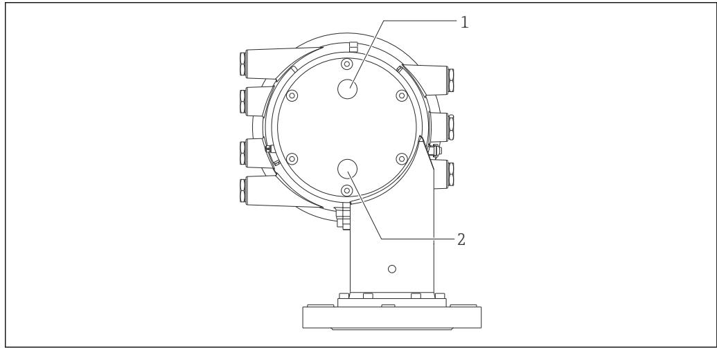
■ 32 Отверстия для очистительного патрубка и патрубка для продувки газом
