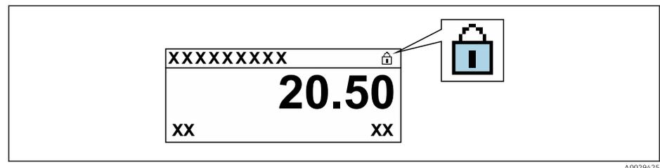
2. Al ajustar el microinterruptor WP del módulo de la electrónica principal en la posición **OFF** (ajuste de fábrica), se desactiva la protección contra escritura.
