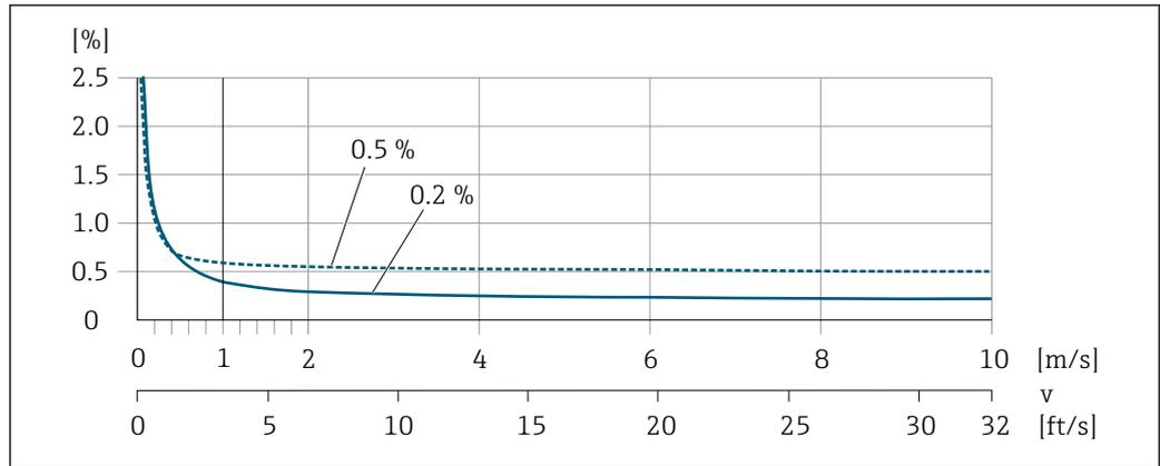
39 Erro medido máximo em % d.l.
