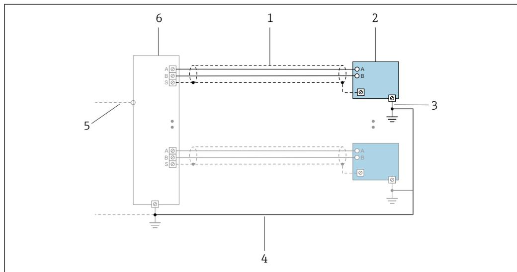
16 Exemple de raccordement pour PROFINET avec Ethernet-APL
