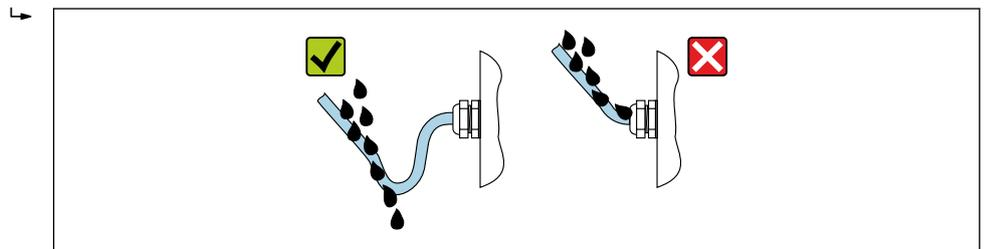
6. Les presse-étoupe fournis ne garantissent pas la protection du boîtier en cas d'utilisation. Ils doivent par conséquent être remplacés par des bouchons aveugles correspondant à la protection du boîtier.
