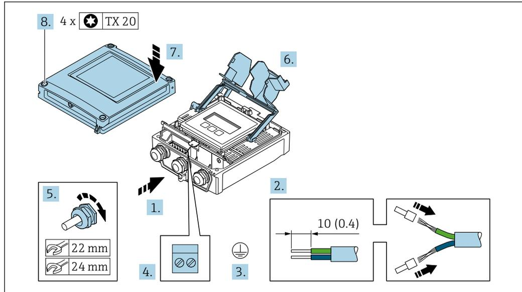
1. Passer le câble à travers l'entrée de câble. Ne pas retirer la bague d'étanchéité de l'entrée de câble, afin de garantir l'étanchéité.
