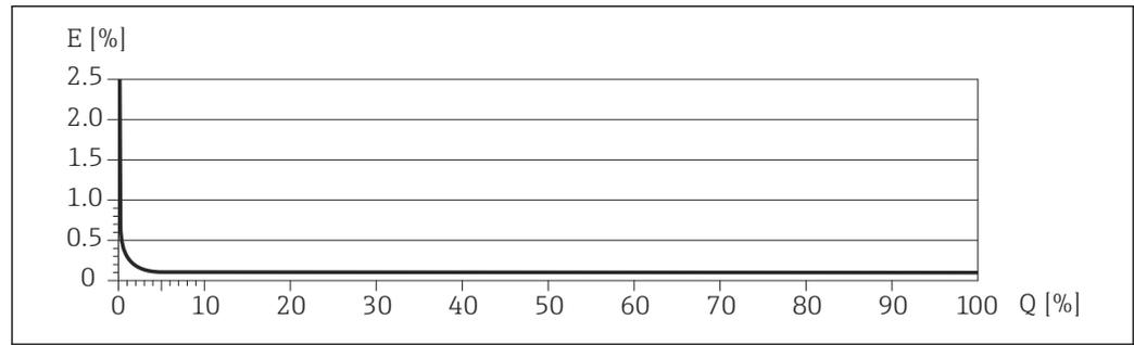
E Error máximo de medición en % v.l. (ejemplo)
