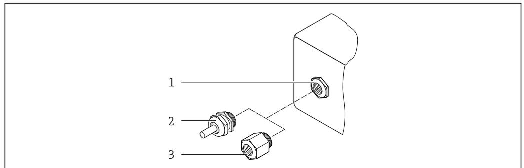
图 17 允许的电缆入口/缆塞
