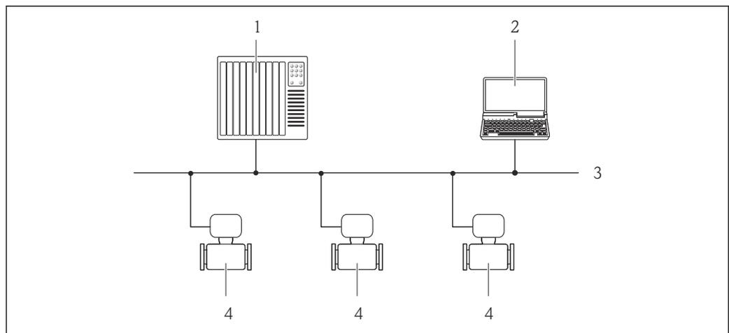
**图 18** 通过 PROFIBUS DP 网络进行远程操作
