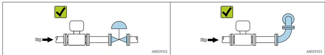
*Dimensões de instalação*
