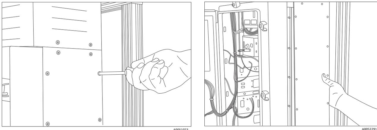
Figure 45. Démontage des vis et du couvercle latéral
