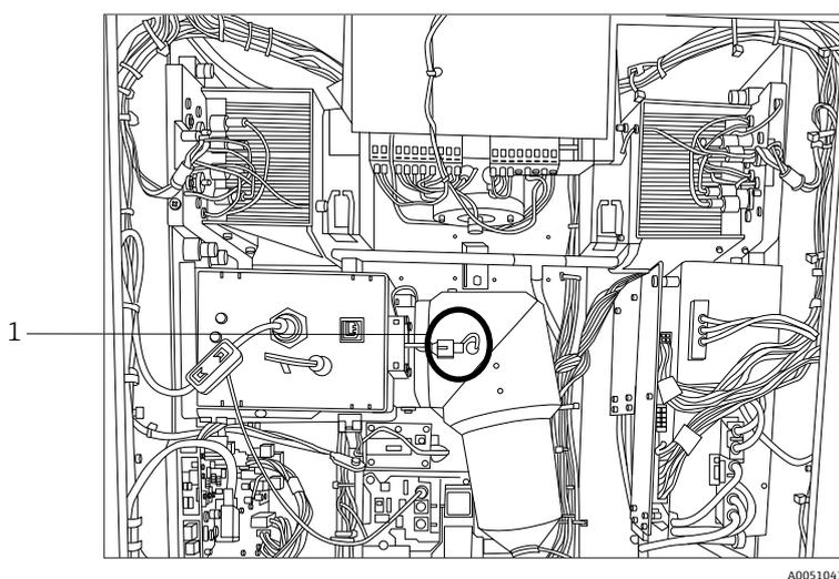
Figure 13. Capteur à réseau (1) pour la régulation thermique
