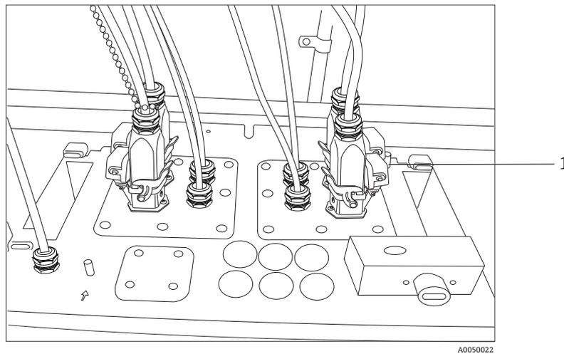
Figure 28. Orifice d'écoulement de l'eau de condensation
