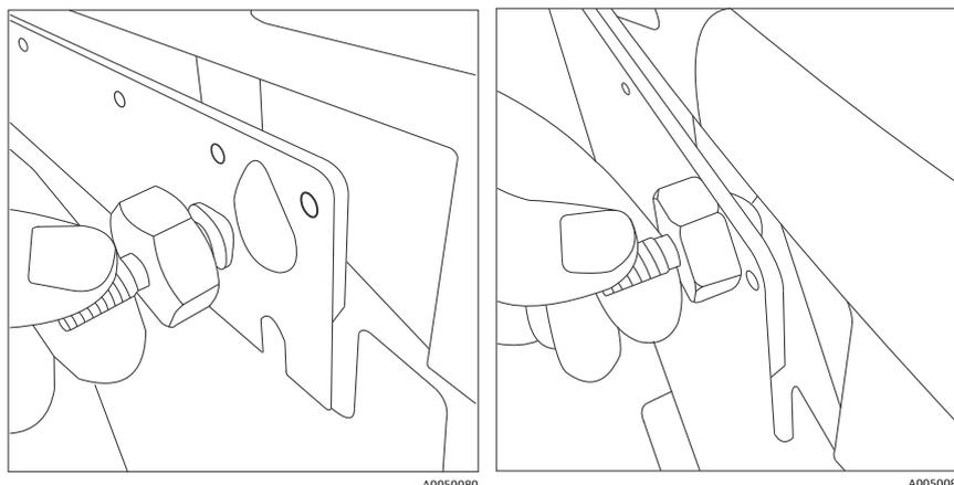
Figure 19. Découpes à l'arrière du boîtier, permettant l'engagement des boulons de montage
