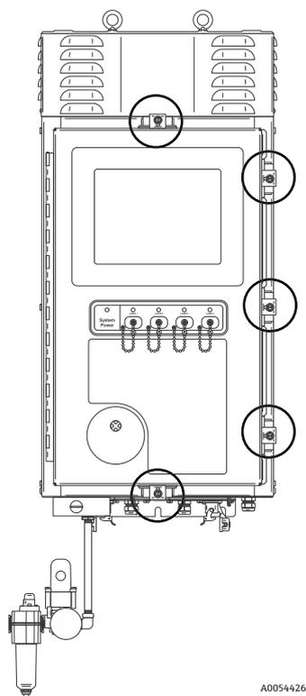
Figure 35. Points de fermeture de la porte
